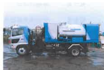
高圧JET洗浄装置搭載時
