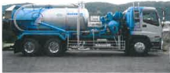
10トンブロワー車1台
