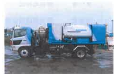
高圧JET洗浄装置搭載時
