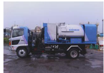
高圧JET洗浄装置搭載時
