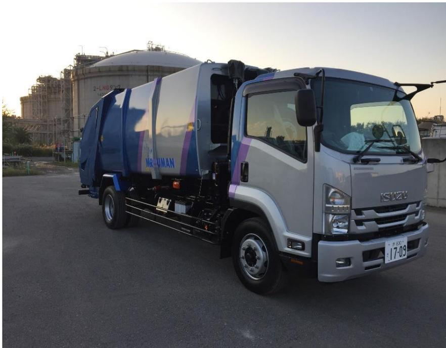
計量装置付7トンパッカー車での回収に変更した場合
