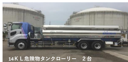
14KL危険物タンクローリー 2台
