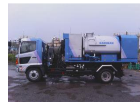
高圧JET洗浄装置搭載時
